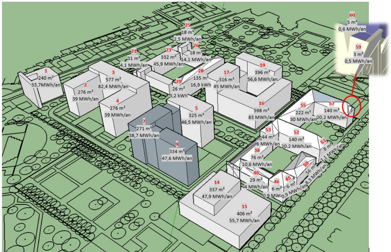
Figure 1 Estimation de la production photovoltaïque des bâtiments du quartier Saint Vincent de Paul. Etude réalisée à partir des plans d'architectes et de sketchUp 3D. (Source : Amoès)
